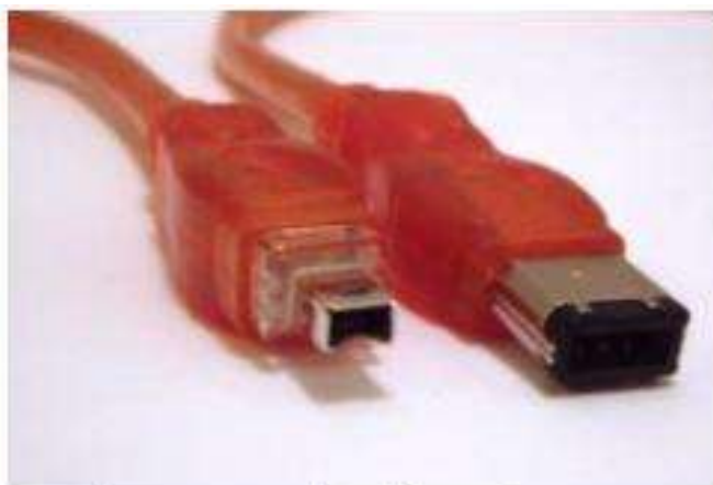
4-pinski (lijevo) i 6-pinski (dsno) FireWire konektori
